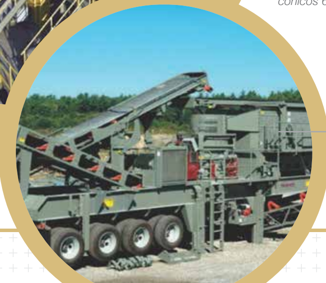
Planta Portátil com britador cônico 44 SBS em circuito fechado
