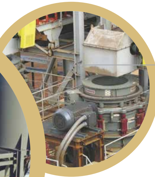
Instalação de britagem automatizada de 1000 ton/hora com os britadores cônicos 68 SBS
