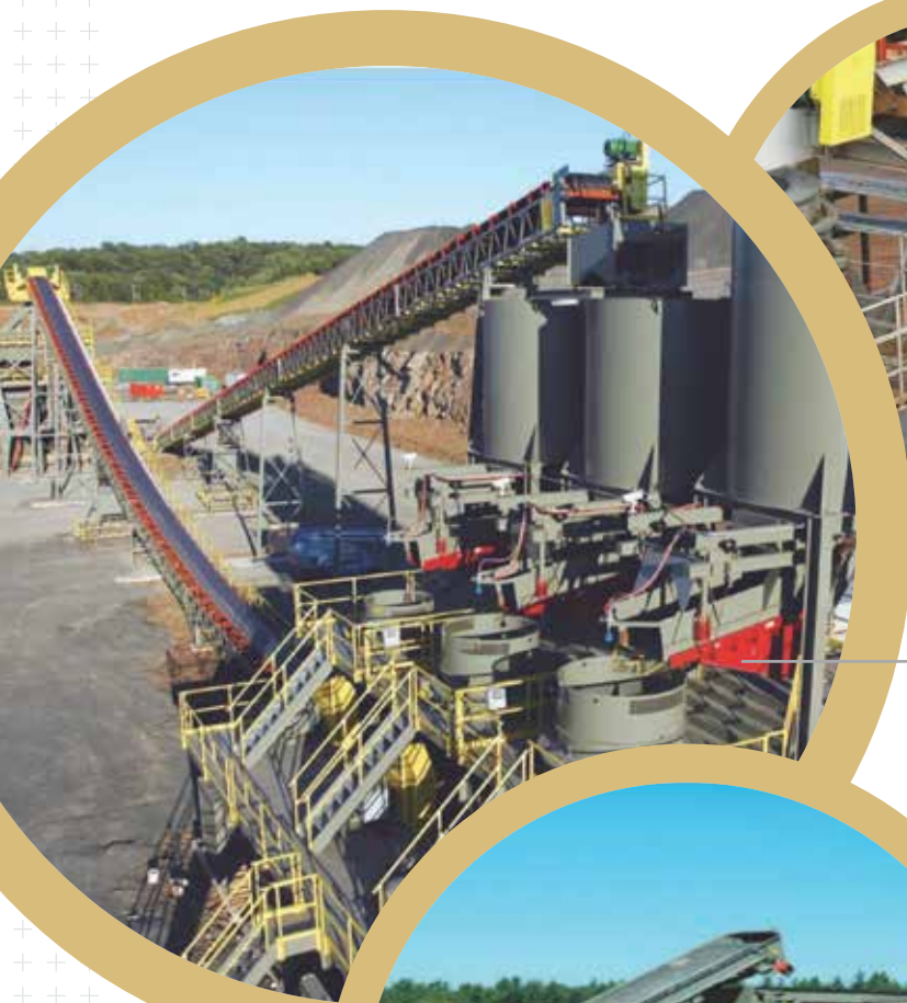
Instalação de britagem automatizada de 1000 ton/hora com os britadores cônicos 68 SBS
