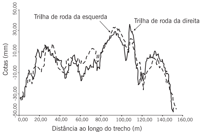
Figura 9.8 Exemplo de levantamento da irregularidade longitudinal por nível e mira (Queiroz, 1984)
