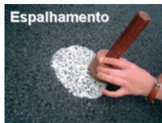
(b) Espalhamento da areia sobre a superfície
