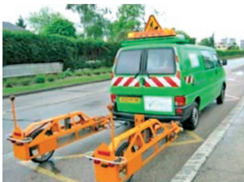
Figura 9.10 Exemplo de equipamento APL francês
