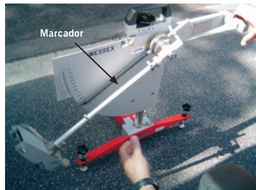
(b) Após atrito sobre a superfície do pavimento quando o pêndulo empurra a haste que marca o valor de VRD
