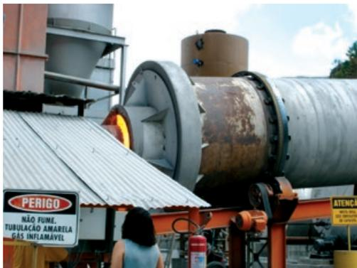
(a) Sistema de aquecimento do secador
