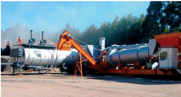
Figura 8.4 Exemplo de uma usina asfáltica contínua
