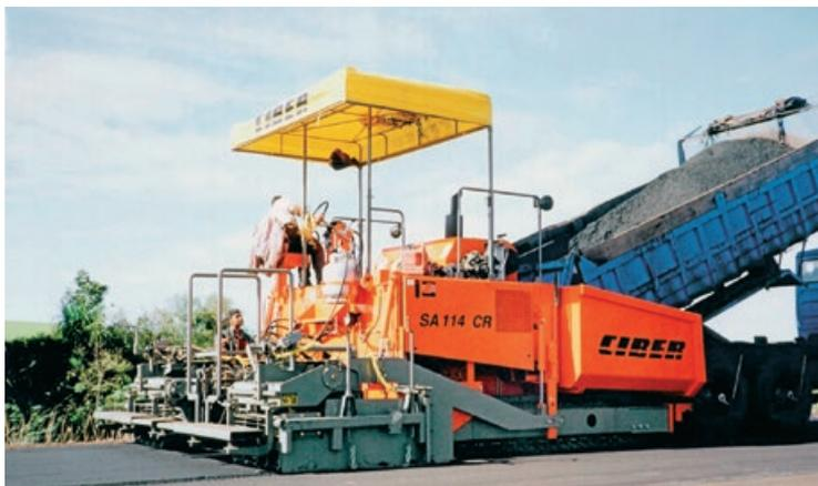
**Figura 8.23** Exemplo de um tipo de vibroacabadora
