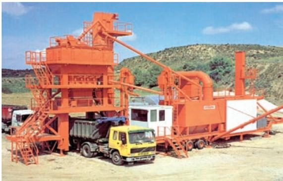
Figura 8.3 Exemplo de uma usina asfáltica por batelada ou gravimétrica
