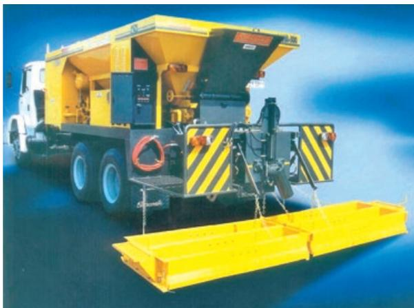
**Figura 8.35** Exemplo de equipamento para produção e aplicação de lama asfáltica
