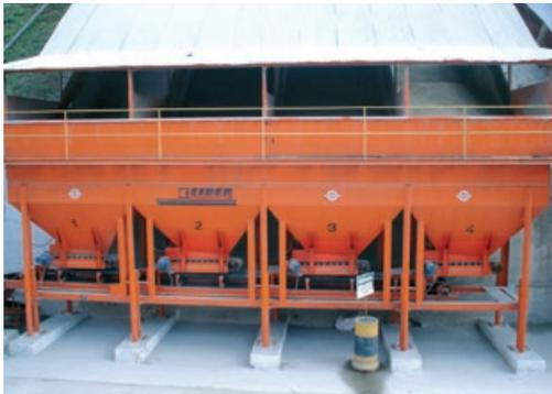
Figura 8.5 Exemplo de estoques e silos cobertos para proteção dos materiais de uma usina gravimétrica
