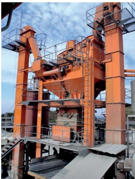
**Figura 8.15** Exemplo de um elevador de agregados aquecidos e silos quentes
