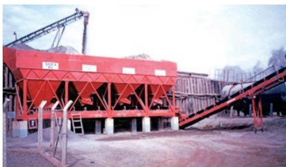
**Figura 8.7 Exemplo de sistema de silos frios**
