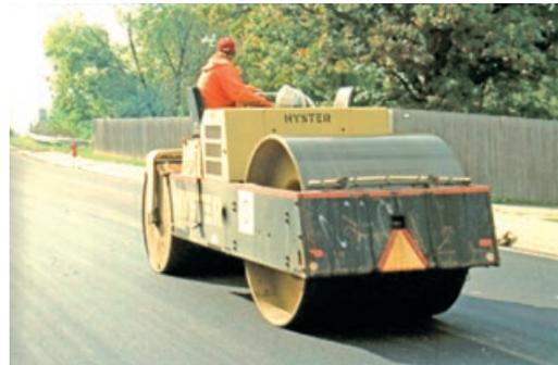
**Figura 8.25** Exemplos de rolo de pneus e rolo tandem liso
