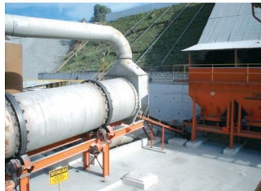
(b) Secador de agregados com ventilador de exaustão
