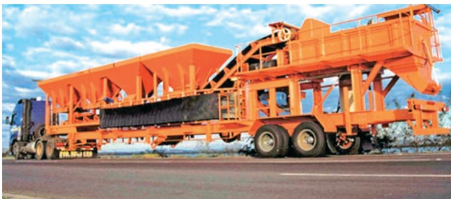
**Figura 8.20** Exemplo de usina de pré-misturado a frio móvel
