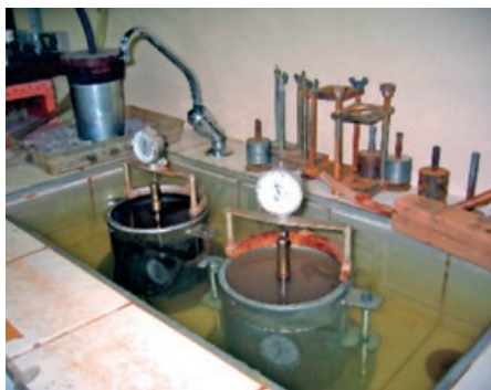
(b) Imersão dos corpos-de-prova em água para medida de expansão axial
