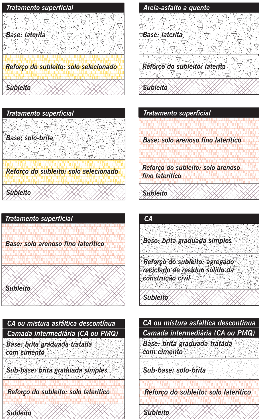
Figura 7.16 Estruturas típicas de pavimentos asfálticos
