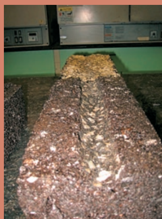
(f) Afundamento da placa
