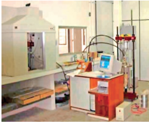
Figura 6.4 Exemplos de equipamento para ensaio de compressão diametral de carga repetida
