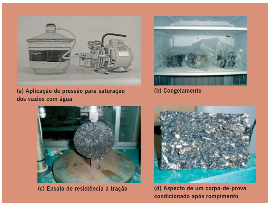
Figura 6.39 Passos para o condicionamento e para a determinação da RT
