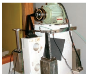
(b) Flexão de corpos-de-prova trapezoidais
