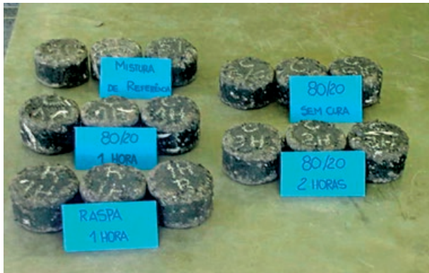
Figura 6.38 Exemplos de corpos-de-prova submetidos ao ensaio Cântabro indicando a determinação do resultado pela média de três corpos-de-prova
