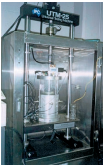
(a) Equipamento americano triaxial (ASTM D 3497)
