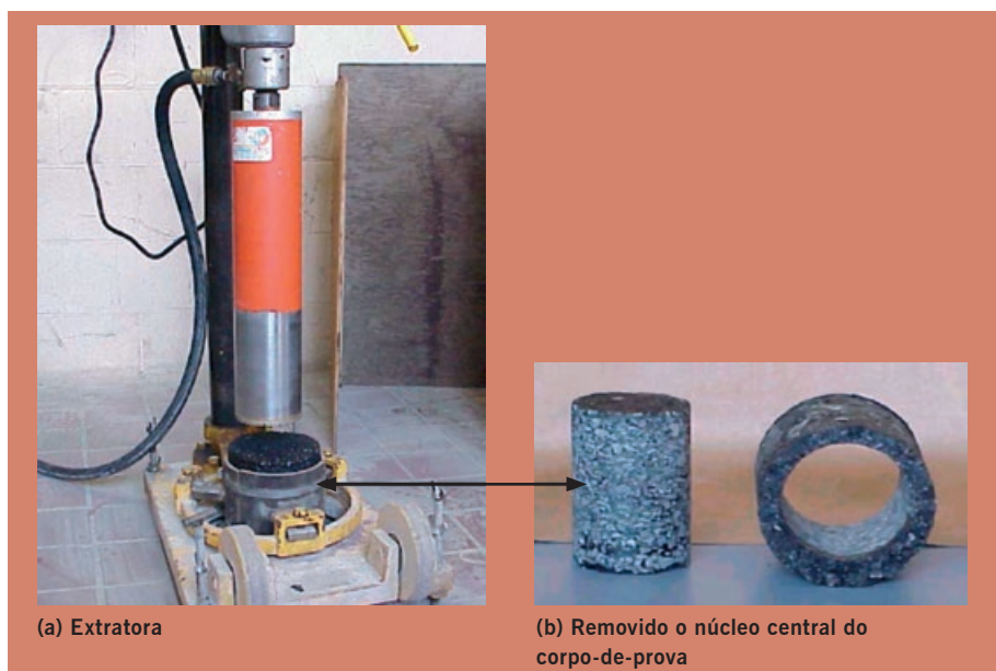
Figura 6.17 Retirada do núcleo do corpo-de-prova
