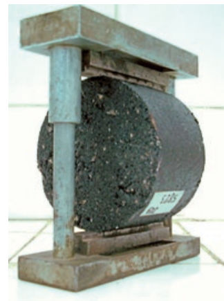
(b) Exemplo de dispositivo centralizador
