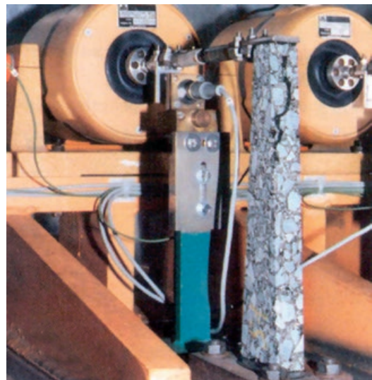
(b) Equipamento francês com corpo-de-prova trapezoidal (NF 98-260-2)
