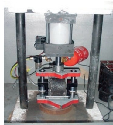
Figura 6.4 Exemplos de equipamento para ensaio de compressão diametral de carga repetida
