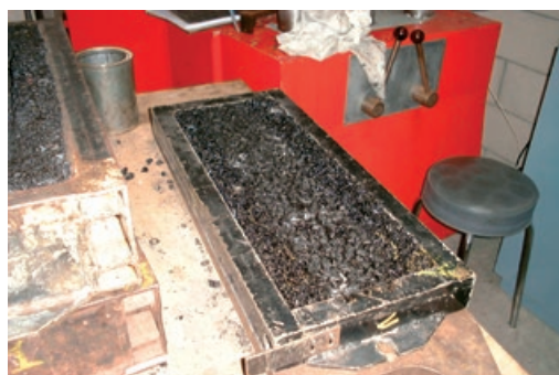
(b) Placa de mistura asfáltica compactada
