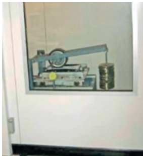
(a) Câmara de temperatura controlada
