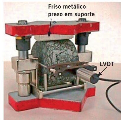
(b) Corpo-de-prova com um único LVDT
