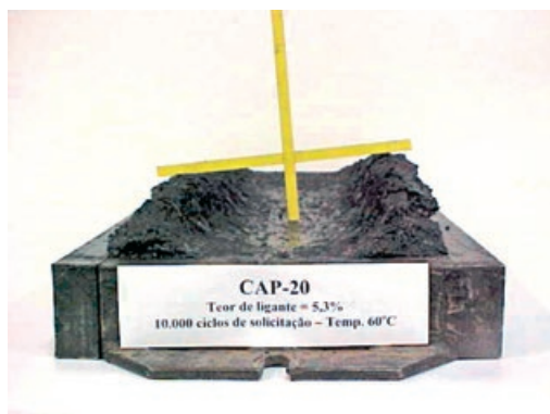
(d) Placa após ensaio de deformação permanente
