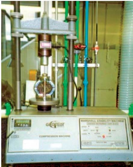
(a) Exemplo de prensa Marshall
