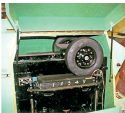
(c) Simulador de tráfego LCPC
