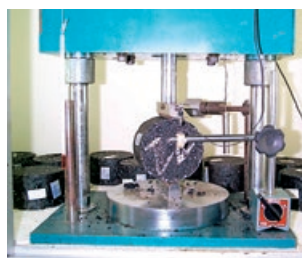
(a) Compressão diametral de corpos-de-prova cilíndricos
