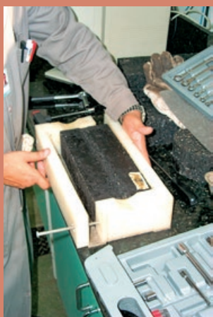
(e) Placa deformada sendo desmoldada
