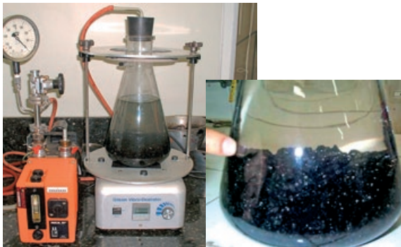
(e) Colocação do conjunto no agitador, aplicação de vácuo e detalhe de desprendimento de ar pela aplicação de vácuo
