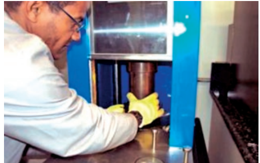
(f) Ajuste do corpo-de-prova para compactação
