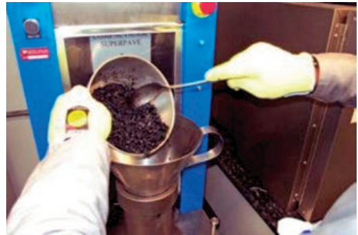
(d) Colocação da mistura no molde
