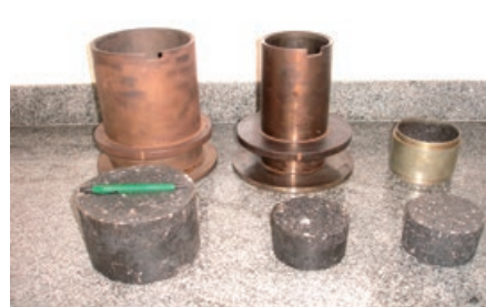
(h) Corpos-de-prova Superpave (diâmetros 150 e 100mm) e corpo-de-prova Marshall (100mm) e respectivos moldes
