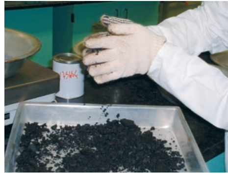
(b) Preparação da amostra de mistura na bandeja
