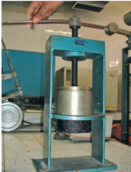
(e) Extração do corpo-de-prova do molde
