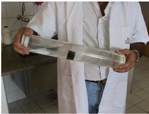
(a) Corpo-de-prova dentro do tubo com água
