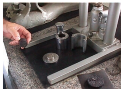
(c) Corpo-de-prova na mão do técnico e equipamentos para sua confecção
