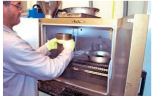
(b) Retirada do molde e material da estufa
