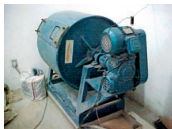
(a) Equipamento Los Angeles
