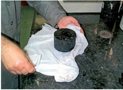
(a) Após retirada da imersão em água
