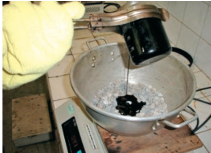
(a) Adição de asfalto aos agregados
