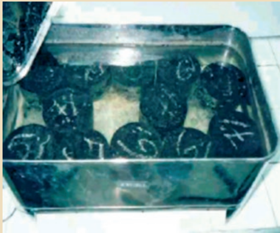
(a) Corpos-de-prova submersos em água a 60°C
