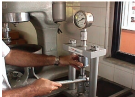
(b) Compactação do corpo-de-prova
