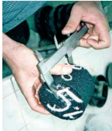
(f) Medidas das dimensões do corpo-de-prova
