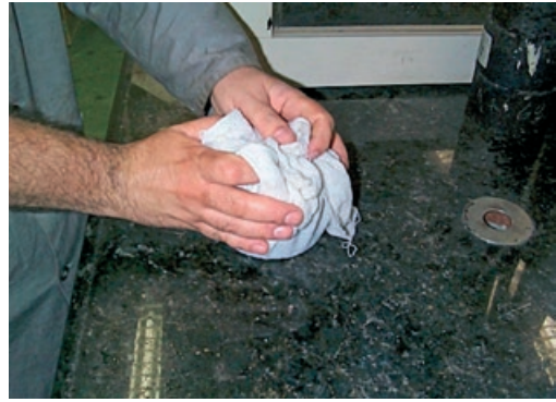
(b) Remoção da água na superfície do corpo-de-prova com toalha absorvente
