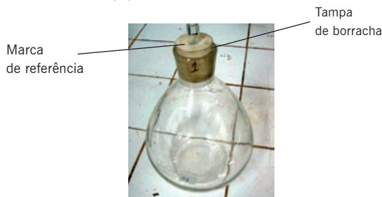
Figura 5.10 Tampa de borracha com orifício preenchido com vidro de diâmetro reduzido
