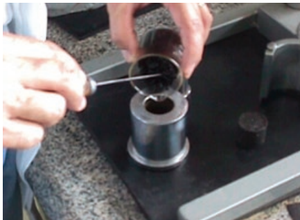
(a) Colocação do material para a confecção do corpo-de-prova
