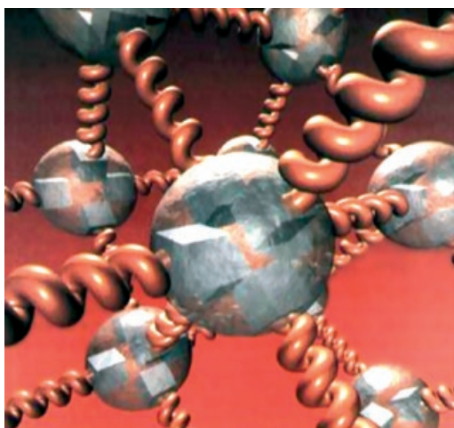
Figura 2.24 Representação esquemática da estrutura de um elastômero termoplástico à temperatura ambiente (Shell, 2003)
