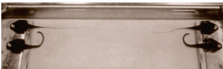
(c) Ruptura do ligante asfáltico
