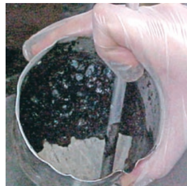
(c) Detalhe da amostra rompida pela ação da solução
