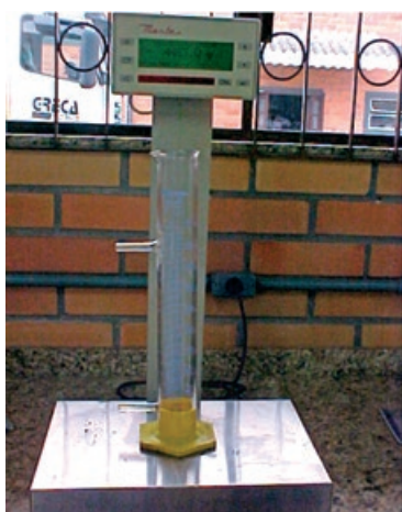
(a) Determinação do peso do equipamento de sedimentação da emulsão
