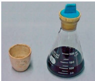
(c) Amostra dissolvida em tricloroetileno para filtragem no cadinho
