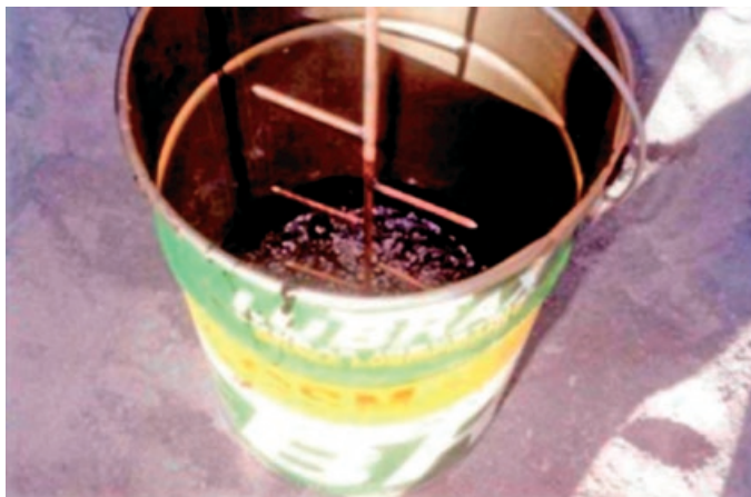
Figura 2.48 Exemplo de esquema de avaliação da taxa de expansão e da meia-vida de um asfalto-espuma em campo
