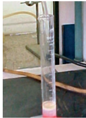
(b) Detalhe do condensado da destilação da emulsão
