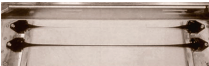
(b) Progressão do ensaio com alongamento do ligante asfáltico
