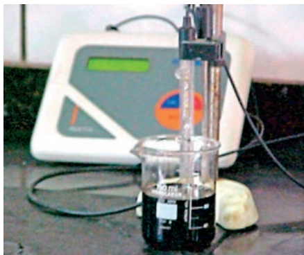
Figura 2.45 Determinação do pH da emulsão
