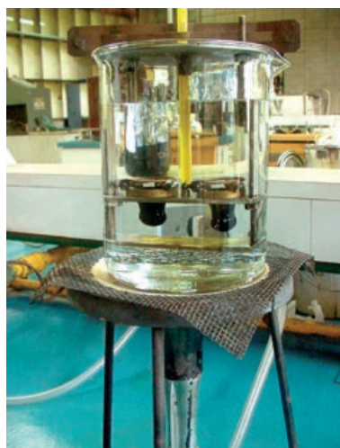
(b) Detalhe esquemático do anel e bola e equipamento manual
