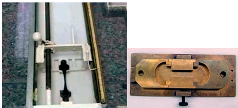
(a) Equipamento com ensaio em andamento e detalhe do molde
