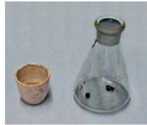
(b) Cadinho com papel-filtro no interior e erlenmeyer com a amostra antes da filtragem
