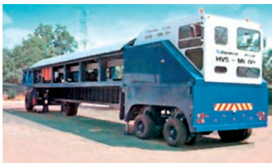
(a) Detalhe da autolocomoção
