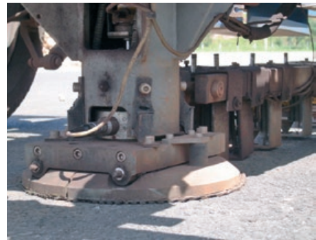
(b) Detalhe do prato de aplicação de carga e da barra de sensores
