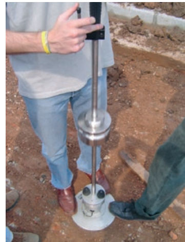
Figura 10.4 Equipamento de avaliação expedita do módulo elástico do pavimento (Foto Abdou, 2005)
