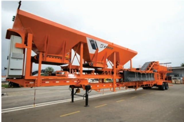
Figura XIII.3 – Usina de solo/PMF móvel
