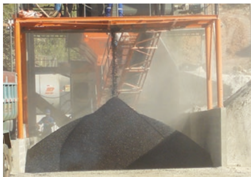
Figura XIII.1 – Produção de PMF em usina de asfalto
