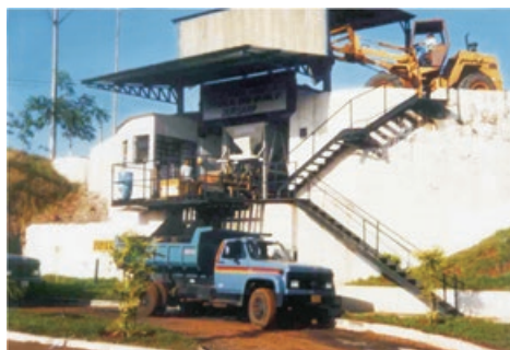
Figura XIII.2 – Usina de solos/PMF de baixa capacidade de produção
