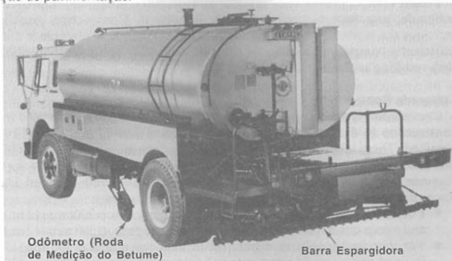
Figura 6.16 Distribuição de Asfalto.
