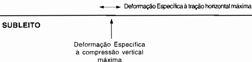
Figura 11.11 Localizações e Direções das Deformações à Tração e à Compressão num Sistema de Pavimento Asfáltico de Espessura Plena
