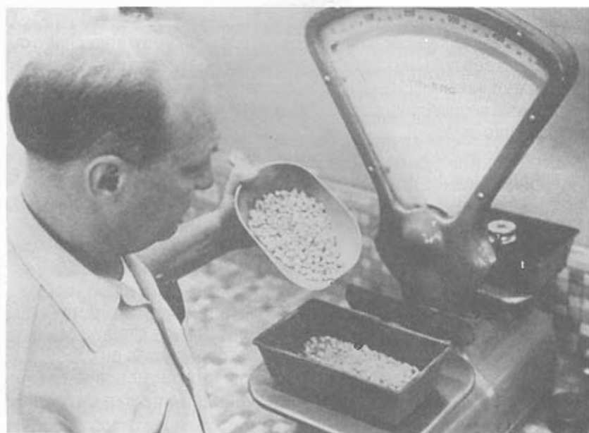
Figura 4.2 Pesagem dos Agregados para as Misturas de Batelada
