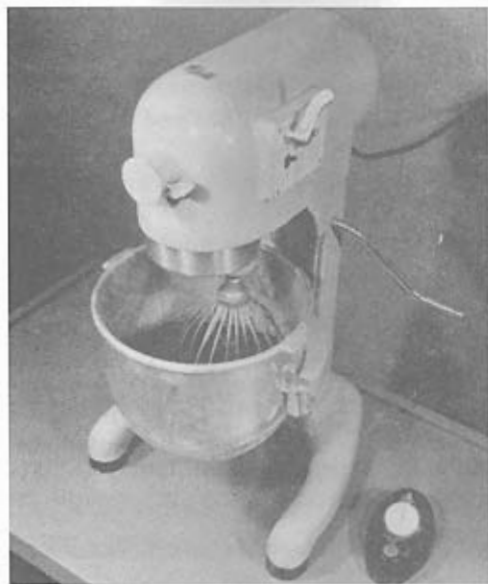
Figura 4.5 Misturador Mecânico usado na Mistura de uma Batelada de Asfalto e Agregado.
