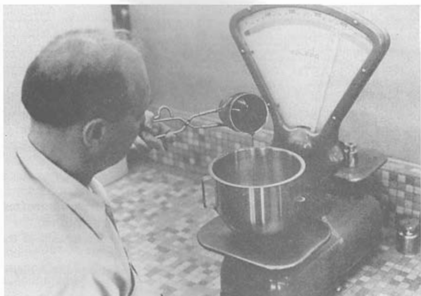
Figura 4.4 Adicionando Asfalto a um recipiente de Aquecimento de Asfalto Controlado Termostaticamente.
