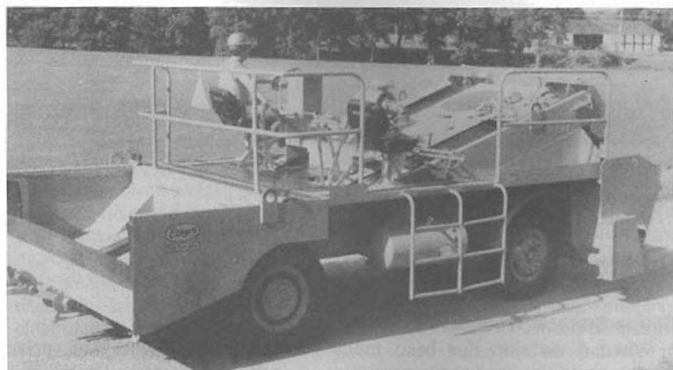
Figura 8.8 (Topo) Escoamento de Agregados Através de Espalhador Mecânico Autopropulsor. (Fundo) Espalhador Mecânico Autopropulsionado.
