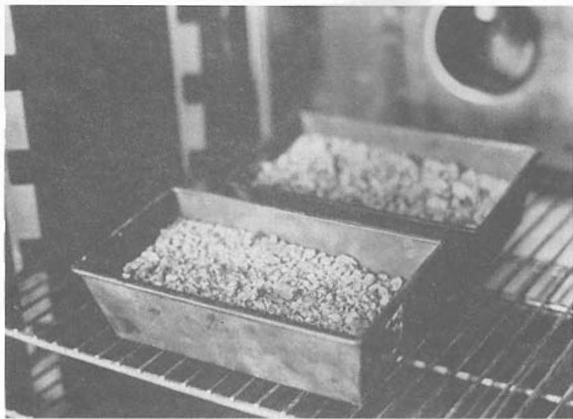
Figura 4.3 Aquecimento de Bateladas de Agregado na Estufa
