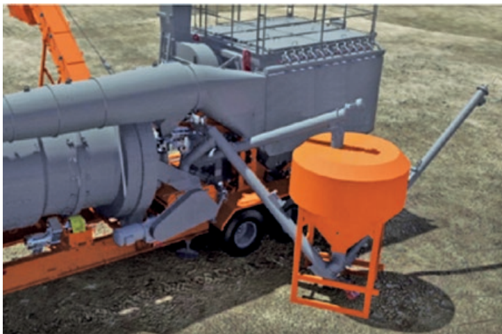
Figura 3.12 (b) Sistema dosador de cal CH-I com silo externo (Fonte: Ciber Equipamentos Rodoviários)
