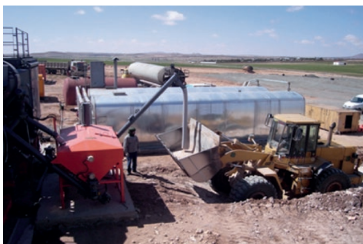
Figura 3.10 (b) Sistema de redosagem de finos com silo externo (Fonte: Ciber Equipamentos Rodoviários)
