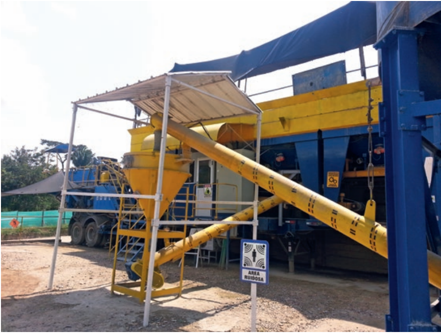
Figura 3.12 (a) Sistema dosador de cal CH-I com silo externo
