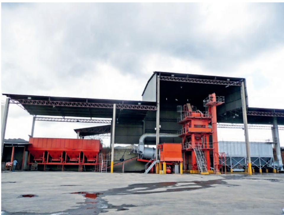
Figura 3.2 (b) Vista de uma usina descontínua (gravimétrica)
