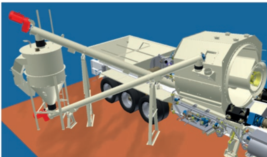
Figura 3.10 (a) Sistema de redosagem de finos com silo externo (Fonte: Bomag Marine LA)
