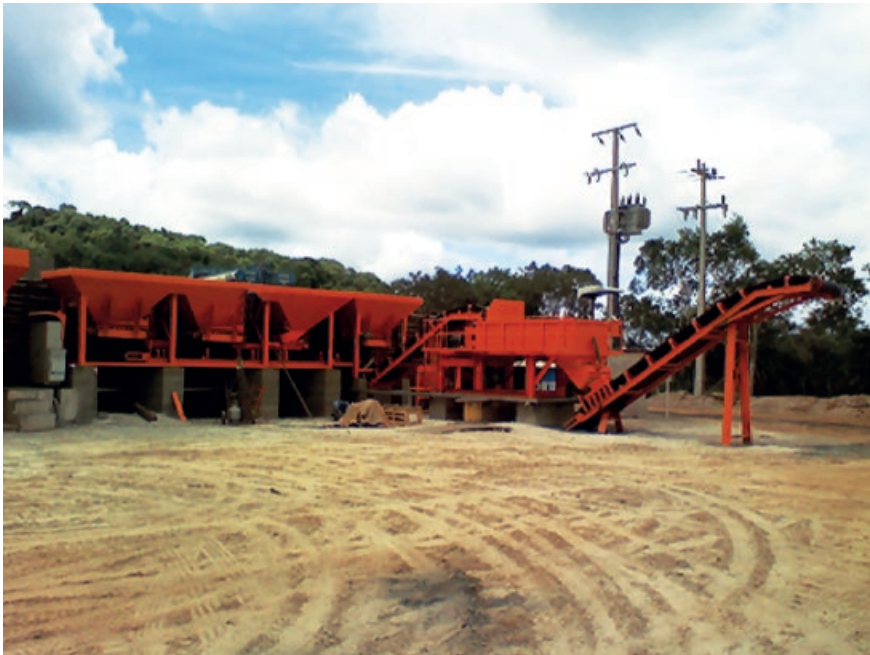
Figura 3.9 Exemplo de usina de solos/pré-misturado a frio (Fonte: Ciber Equipamentos Rodoviários)
