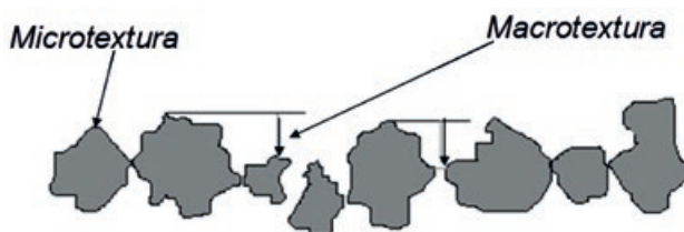
Figura 2.1 Micro e macrotextura na superfície de um revestimento asfáltico
