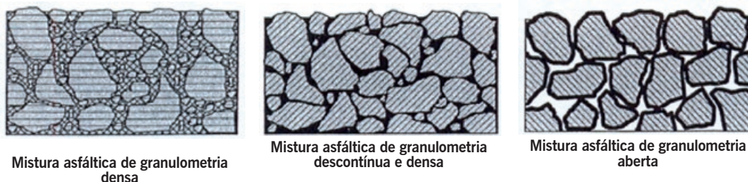
Figura 1.1 Ilustração esquemática dos três tipos de distribuição granulométrica das misturas asfálticas
