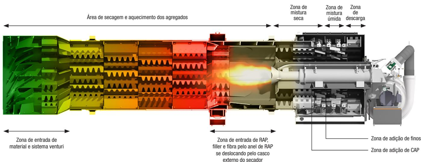
Em seguida, esta mistura a seco, já homogênea, entra no compartimento de mistura onde será adicionado o ligante asfáltico (CAP), em um compartimento totalmente isolado da chama do
